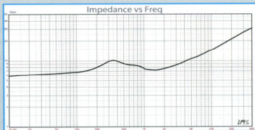
FIGURE 9: Morel EM 1308 free-air impedance plot.
